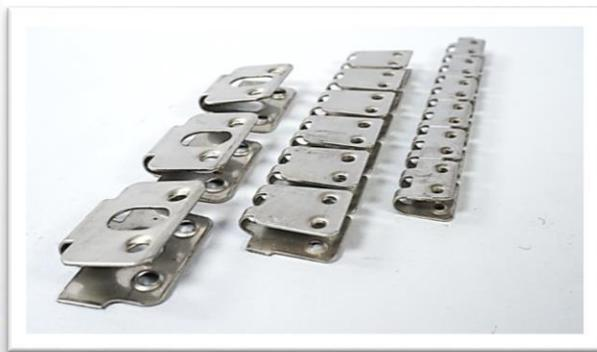
Le **MINET**, sono state le prime giunzioni apribili prodotte per unire le tele dei tappeti a nastro. Il serraggio avviene tramite l'utilizzo di chiodini di rame, che vengono ribattuti su se stessi.
