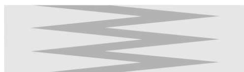
Giunzione saldata per nastri per trasportatori di spessori e misure ridotte dove è necessario avvolgere su piccoli diametri. Particolarmente idonea per nastri elastici di larghezze minime a partire da 5 a 50mm.
