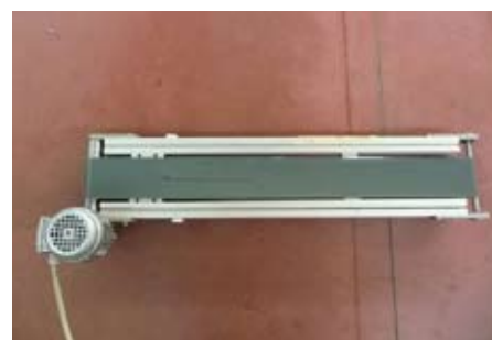
Foto del muletto di collaudo prodotto per la valutazione della variazione al modulo elastico di pre-tensionamento. Dai test eseguiti dopo un collaudo di 10 mesi di lavoro si è stabilita la % idonea al montaggio del prodotto compresa tra un minimo del 4% ed un max. dell'8% in funzione dello spessore e della durezza del nastro Elastodect® .
