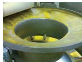
Imbuto di raccolta pasta secca su bilancia pesatrice.
