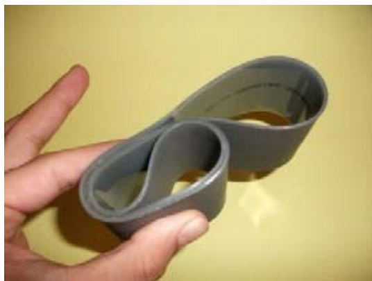
Esempio di massima flessibilità del nastro 2L-EI7-MD80-TL.
